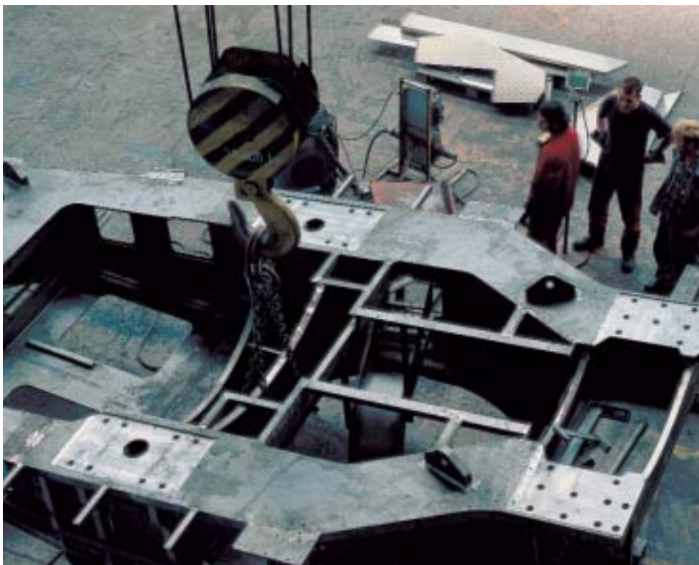
Unbeschichteter Maschinenträger SIAG CZ, Chrudim
