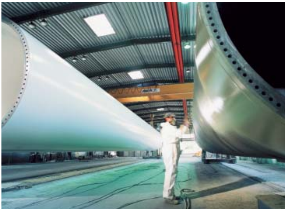
Konservierung einzelner Turmsegmente, Finsterwalde
