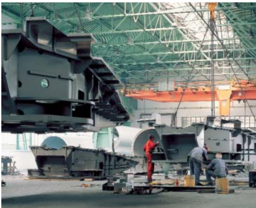
Serienproduktion von Maschinenträgern SIAG CZ, Chrudim Serial production of mainframes SIAG CZ, Czech Republic
